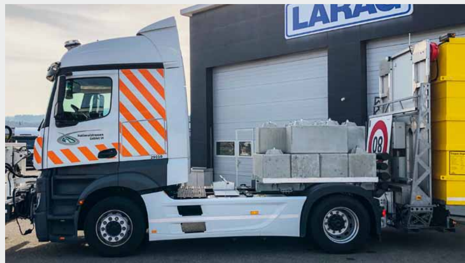
SwissBlock®-TEC kraftschlüssig mit Fahrgestell verschraubt.
